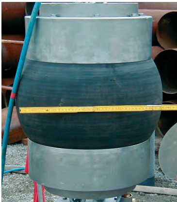
Bild 4: Druckprobe vor dem Einbau des Doppelpackers
