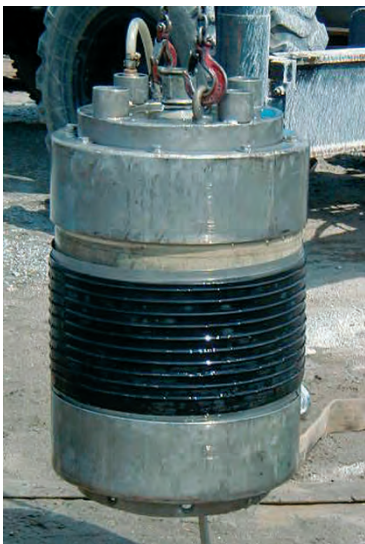
Bild 6: Für den Setzvorgang der Innenrohrmanschette vorbereiteter Einfachpacker
