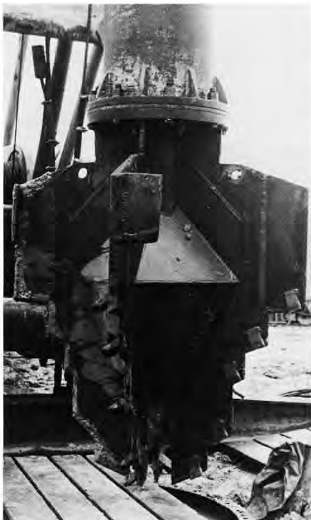
2 Kastenmeißel (Ø 1,5 m), besetzt mit Reißzähnen
