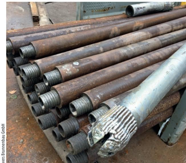
Abb. 4 – Doppelwandgestänge für Injektionsbohrungen
